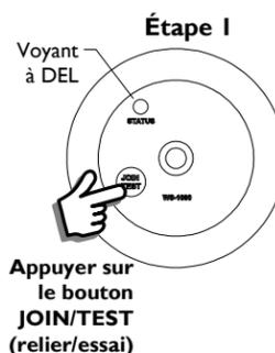
Appuyer sur le bouton JOIN/TEST (relier/essai)
