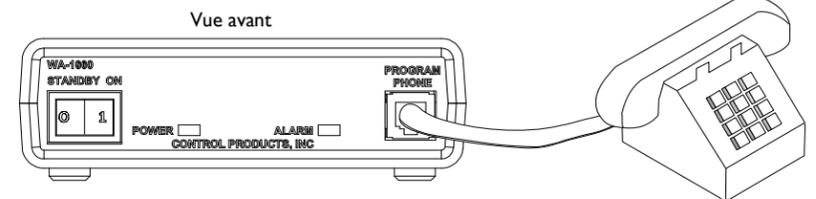
2. Mettre L'INTERRUPTEUR À BASCULE du panneau avant sur la position STANBY (attente) - le voyant à DEL clignotera.
