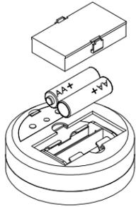
**Remarque :** Une fois les piles installées, laisser le capteur à l'envers afin de mettre en sourdine le bip de 90 dB, qui commence dans environ 30 secondes, et qui émet un bip toutes les 10 secondes par la suite jusqu'à ce qu'il soit relié à la station de base WA-1000.
